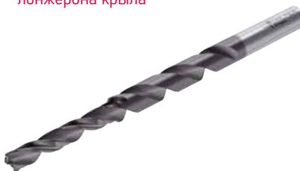
4 режущие кромки AFA1N обеспечивают высокую стойкость при обработке пакетов CFRP/металл, а также минимизируют образование заусенцев. Кроме того, неметаллическое покрытие NHC (углеродный слой ta-C) уменьшает наростообразование.
