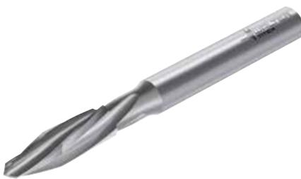
Этот зенкер с левой спиралью направляет стружку вперед, в предварительно обработанное отверстие. Если последовательно обрабатываются CFR и титан, то титановая стружка не повреждает CFRP. При обратной последовательности обработки рекомендуется использовать этот же инструмент, но с правой спиралью.
