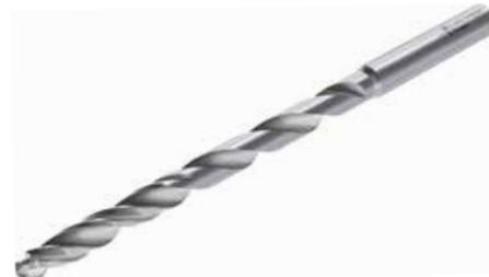
Инструмент можно использовать для ручного сверления или растачивания. Четыре направляющие ленточки стабилизируют инструмент, а дополнительные канавки препятствуют наростообразованию при сверлении алюминия без СОЖ.
