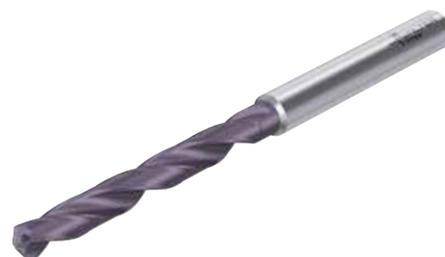
Вибросверло для обрабатывающих центров и сверлильно-клепальных автоматов отличается высокой эксплуатационной надёжностью. Этот инструмент подходит для обработки пакетов CFRP/Ti при большой толщине материала и жёстких допусках.
