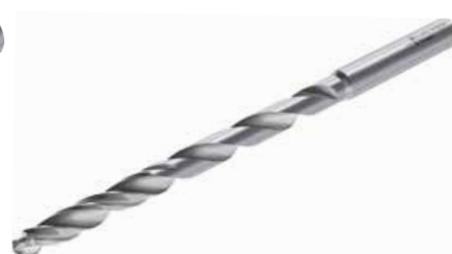
Инструмент можно использовать для ручного сверления или растачивания. Четыре направляющие ленточки стабилизируют инструмент, а дополнительные канавки препятствуют наростообразованию при сверлении алюминия без СОЖ.
