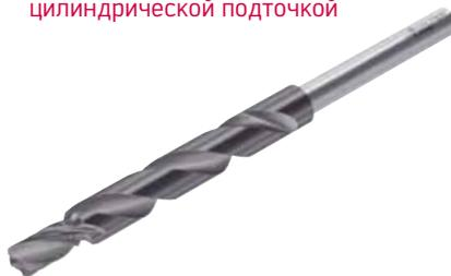
Покрытие NHC (с углеродным слоем ta-C) твёрдостью 5000 HV эффективно замедляет износ инструмента. Гладкий слой уменьшает наростообразование. Кроме того, 4 режущие кромки сверла заметно повышают стойкость.
