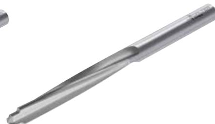
Walter Titex MFA5 предназначено для ручной обработки пакетов CFRP/Al и Al/Al. Небольшой угол подъёма стружечных канавок сверла уменьшает его скорость на выходе.
