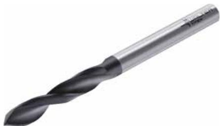
Геометрия AF1D с алмазным покрытием подходит для обработки отверстий в CFRP с одно- и разнонаправленными волокнами. В комбинации со сверильной установкой эта геометрия также обеспечивает превосходную круглость отверстий и точное соблюдение размеров благодаря способности к самоцентрированию.
