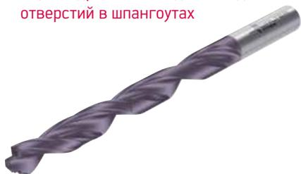
Это сверло было специально разработано для сверлильных установок. Шлифованные стружечные канавки и гладкое, теплостойкое покрытие ACN (нитрид алюминий хрома) обеспечивают оптимальный отвод стружки.
