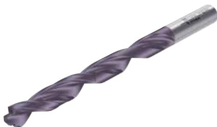
Этот инструмент предназначен для использования в сверлильных установках. Шлифованные стружечные канавки и гладкое теплостойкое покрытие ACN обеспечивают оптимальный отвод стружки.
