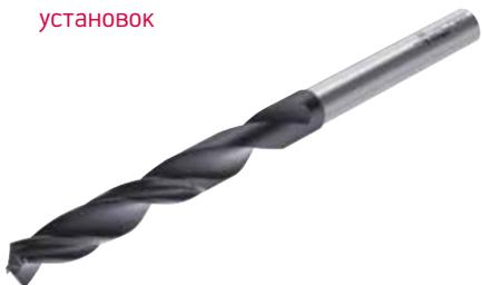
Сверло Walter Titex AFF1D с 4 режущими кромками и алмазным покрытием специально разработано для многоосевых сверильных установок и оптимально подходит для использования в роботах. Несмотря на высокую стойкость не требуется доводочных работ на выходе из отверстия, если присутствует молния защиты (медная сетка).
