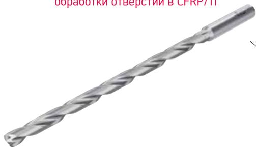
Titex AFT2 – это сверло 16 x D<sub>C</sub>, которое предназначено для обработки глубоких отверстий. С помощью этого инструмента возможна обработка пакетов CFRP-титан, а также CFRP-нержавеющая сталь.
