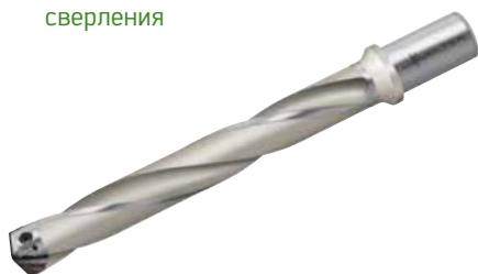
Оптимально подходит для обработки пакета CFRP/Al за одну операцию. Экономичное решение для обработки отверстий диаметром 12–38 мм. Максимальная эксплуатационная надёжность благодаря пластинам с оптимизированной геометрией в проверенном корпусе Xtra-tec® Point Drill и высокой точности отверстий благодаря дополнительным направляющим ленточкам.
