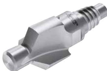
Направляющая зенковки помогает позиционировать инструмент и центрировать его при переходе от сверления к зенкерования. Инструмент доступен в исполнении Z = 2 или Z = 3 и подходит для зенкерования от 10 мм, а также позволяет сократить издержки.
