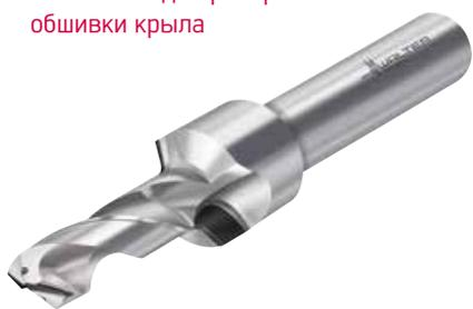
Режущая геометрия AFA1P специально адаптирована для обработки пакетов CFRP/Al. Острая режущая кромка и внутренние каналы для подвода СОЖ или охлаждения масляным туманом сводят образование заусенцев к минимуму даже при обработке пакетов с алюминием.
